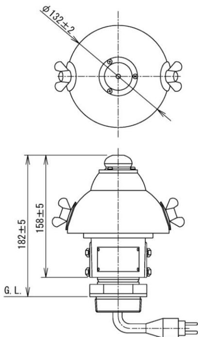
※水平調整ねじの調整により、水平調整履歴を残すことができます。
