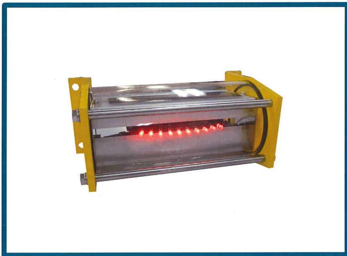
本灯器は、岸壁・棧橋の壁面に設置するだけで、船舶の接舷場所や岸壁の境界を明示します。昼間に太陽電池により内臓蓄電池に充電して、周囲が暗くなると高輝度LEDが自動的に発光します。特に、無日照補償が約1週間（6日間）と長く、防水性能の優れた、低コストで独立電源の、メンテナンスフリーの照明機器です。
