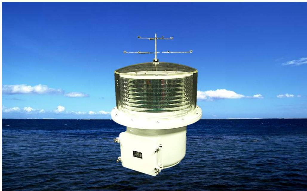
高光度LED灯器は、世界に先駆けてLED灯器の実用化をした当社の技術を集めたものです。LEDからの光を効率良く遠くまで届くように設計された、多段型円筒レンズの採用や電源が変動してもLEDに流れる電流を一定に保つ定電流回路が内蔵されており、太陽電池等の変動の多い電源に最適な灯器です。
